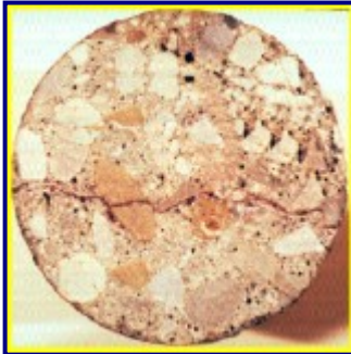
Carote extrase din zonele injectate gravitațional
