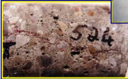
Carote extrase din zonele injectate gravitațional
